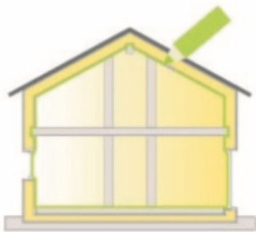
Figur 1. Pencil-Rule – en regel för planering och verifiering av det lufttäta skiktet i en
